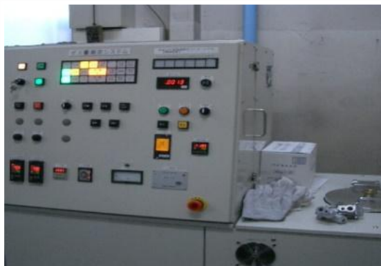
ガス量測定装置
