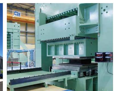
35000kN二軸試験機(川金コアテック茨城工場) 35000kN double axis testing machine (Kawakin Core-Tech Ibaraki Plant)
