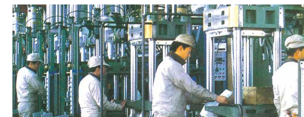
射出成形機生産ライン Production line of injection-molding machines
