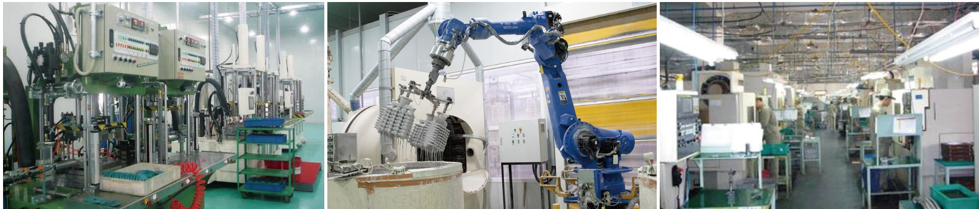
在自动化精密铸造工厂中， 可实现每月数千个至数十万个的生产量 大幅缩短干燥时间，实现少人数高效生产的 自动涂覆设备 依托自有加工设备，确保加工成品经过 快速且充分的检查
