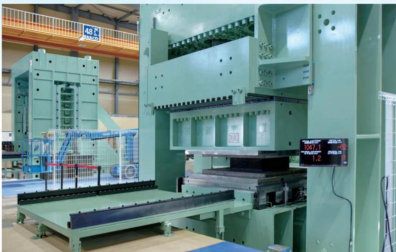
川金コアテック茨城工場に設置されている国内最大級の大型二軸試験機 名称「3500TF」
